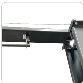
Switch de paro automático en travesaño
