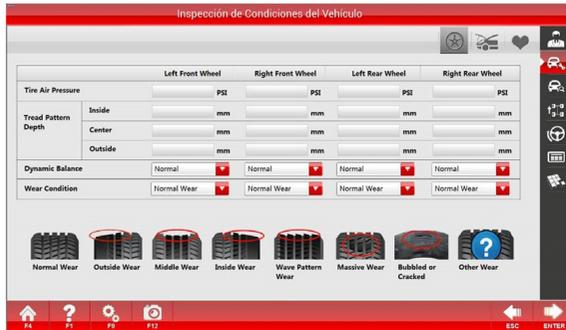
Inspección de la condición de los neumáticos
